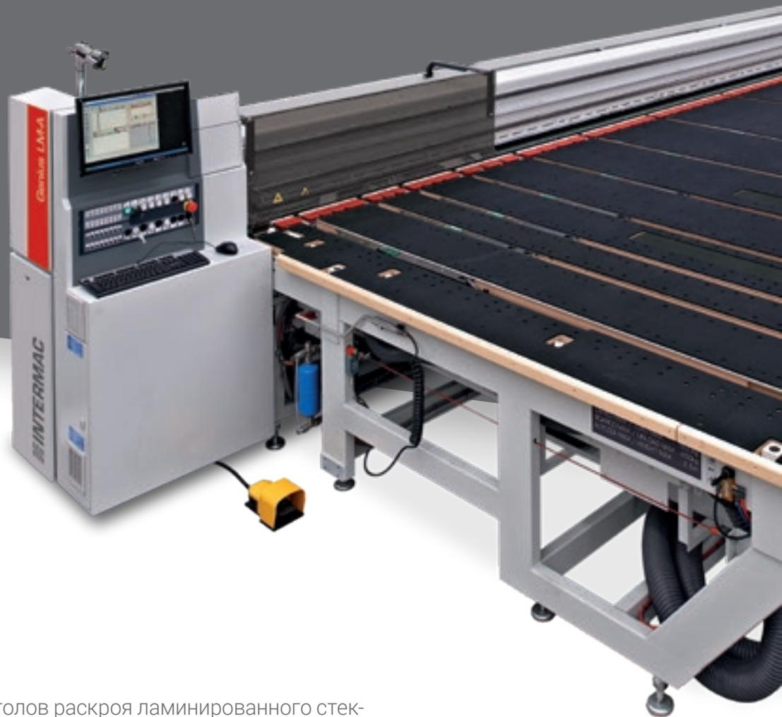
**Genius LM-A** - это серия столов раскроя ламинированного стекла, предназначенная для предприятий, которым требуется высокий уровень производительности. м. в смену - с возможностью полностью автоматизировать весь цикл загрузки стекла и выгрузки готовой продукции. Это совершенно инновационный станок, запатентованный Biesse, который позволяет внедрить линию для ламината, занимающую значительно меньшую триплекса, без необходимости отказываться от требуемой производительности оборудования.
