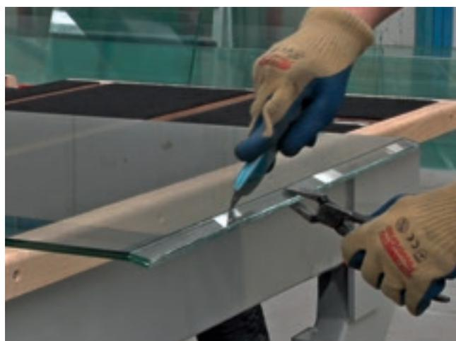
Резка + автоматический разлом + ручное отделение 20 мм.
